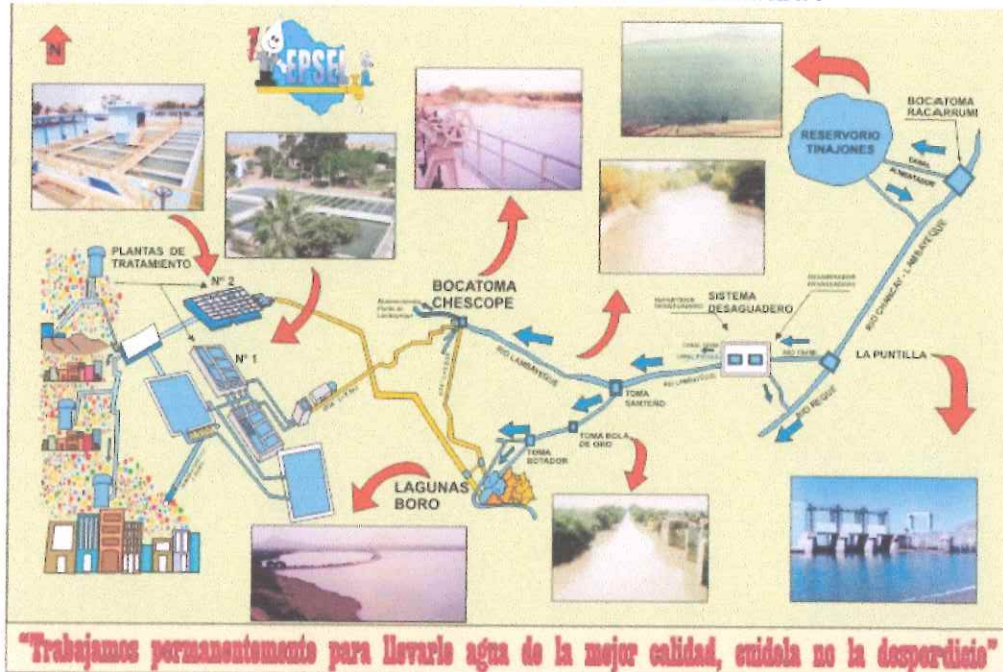
IMAGEN 2: SISTEMA DE ABASTECIMIENTO DE AGUA POTABLE PARA CHICLAYO
